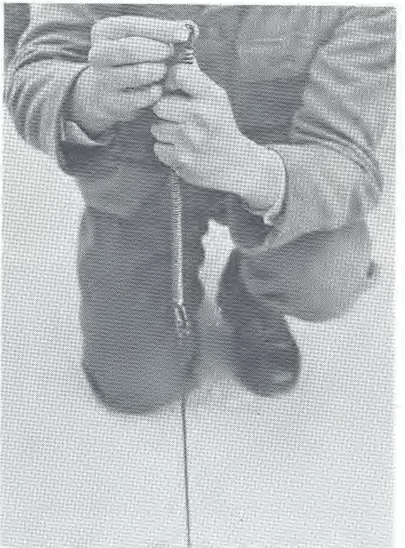
Sl. 74 – Sklapanje povratnog mehanizma puškomitraljeza
